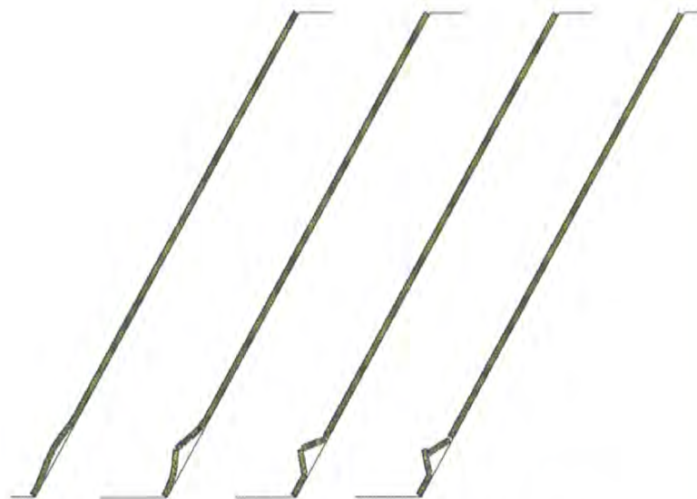
Fig. 14 Failure sequence – Transition from flexural to three-hinge buckling. Bild 14 Versagensablauf – Übergang vom Biegeknicken zum Dreigelenknicken.
